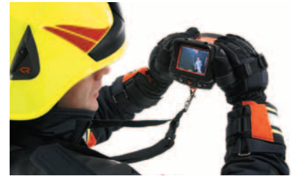
Der Nackengurt aus NOMEX kann vorne an der Kamera eingehängt werden.
