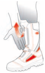
4) Druck-Drehknopf mit Handkante zu drehen bis der Stiefel optimal sitzt!
