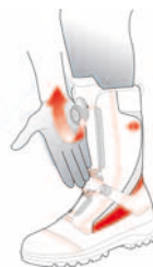
4) Serrer le bouton pression rotatif à l'aide du bord de la main jusqu'à ce que la botte soit ajustée comme il faut.
