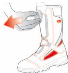
1) Tirer sur le bouton pression rotatif
